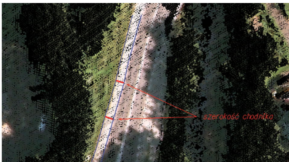
Ryc. 6.73. Wyznaczanie szerokości elementów pasa drogowego na podstawie chmury punktów ALS
