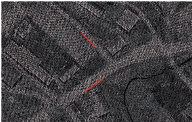
Ryc. 5.7. Obiekt sytuacyjny stosowany w procesie kontroli jakości, wyodrębniony na podstawie szczegółów terenowych (krawędzie jezdni) wizualizowanych na obrazie intensywności
