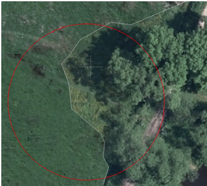
Ryc. 5.28. Błąd wyrównania tonalnego na cyfrowej ortofotomapie lotniczej w miejscu przebiegu linii łączenia sąsiednich zdjęć
