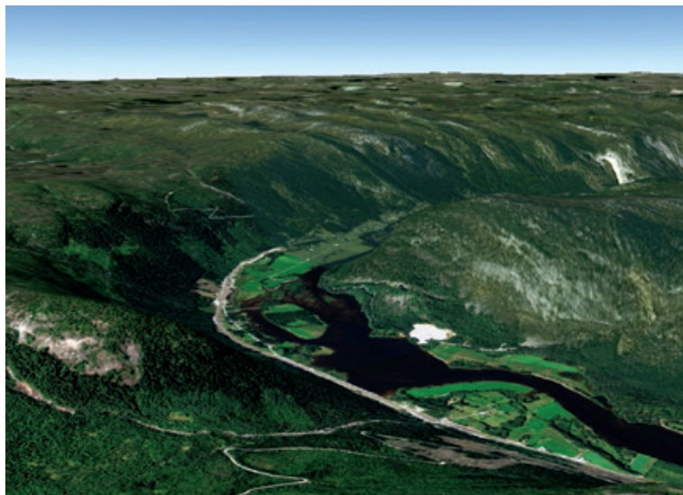
Ryc. 6.88. Level Of Detail 0 – numeryczny model terenu udrapowany cyfrową ortofotomapą – Linkoping (źródło: kartan.linkoping.se/3d )
