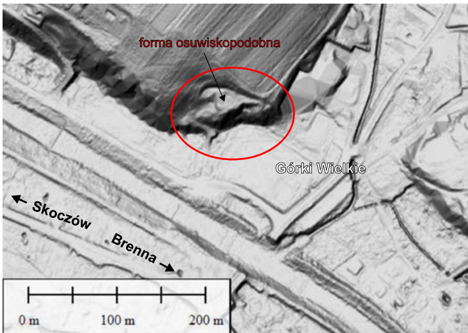
Ryc. 6.12. Forma terenu przypominająca osuwisko. Antropogeniczne zmiany rzeźby terenu pod kątem budowlanym. Wizualizacja danych opracowanych w ramach projektu ISOK
