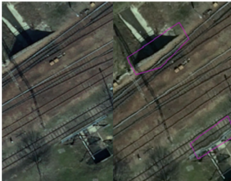
Ryc. 5.25. Poprawna geometria na zdjęciu lotniczym (po lewej), zniekształcenia geometryczne występujące na cyfrowej ortofotomapie (po prawej)
