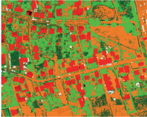
Ryc. 3.20. Sklasyfikowana chmura punktów ALS (ISOK) – kolorowanie po atrybucie klasy (pomarańczowy – grunt; czerwony – budynki; zielone odcienie – roślinność; białe – niesklasyfikowane)
