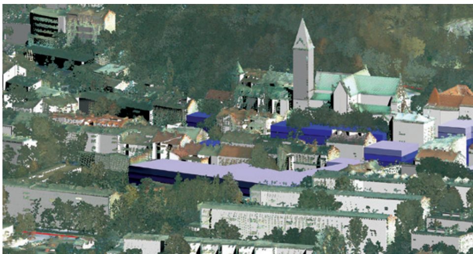
Ryc. 6.40. Wizualizacja planowanej zabudowy (wektorowe bryły) z wykorzystaniem chmury punktów oraz wektorowego modelu miasta wygenerowanego z chmury punktów ALS (źródło: Biuro Planowania Przestrzennego Urzędu Miasta Krakowa)
