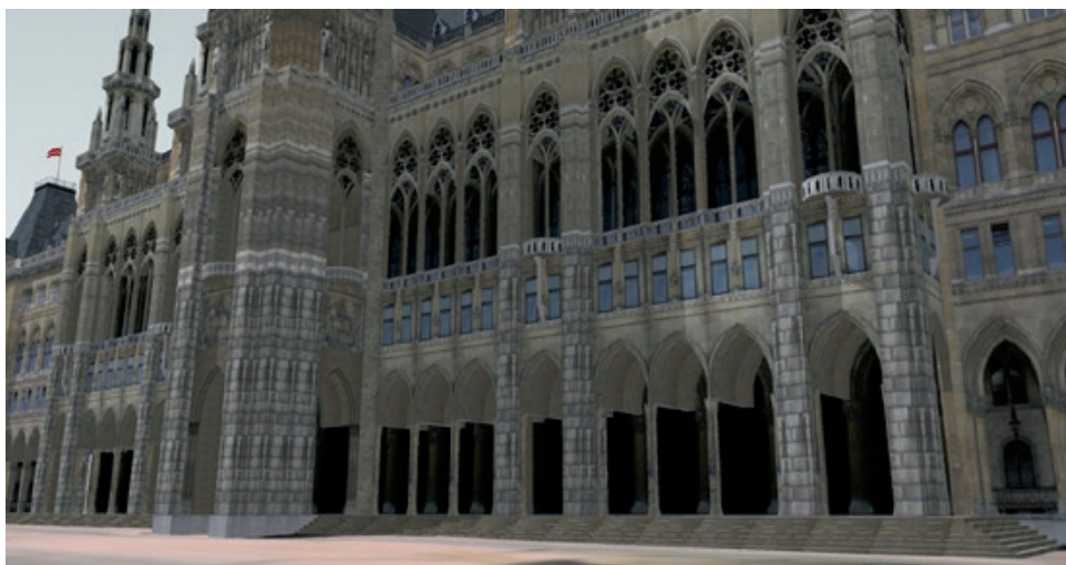
Ryc. 6.91. Level Of Detail 3 – model budynku wzbogacony o szczegółowe elementy architekto- niczne – Wiedeń (źródło: blog Miasta3D )
