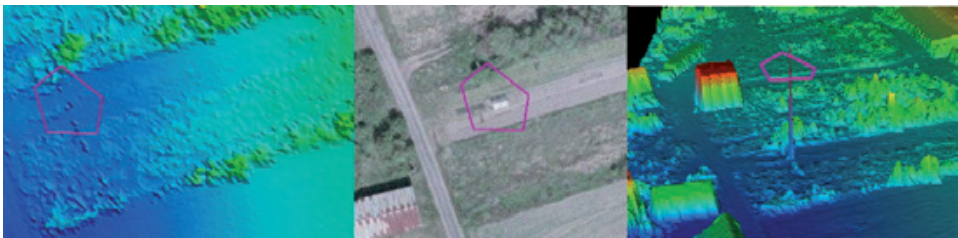
Ryc. 5.21. Piki wysokościowe na NMPT „w górę” (od lewej: widok NMPT, widok na podkładzie ortofotomapy cyfrowej oraz NMPT – widok izometryczny)
