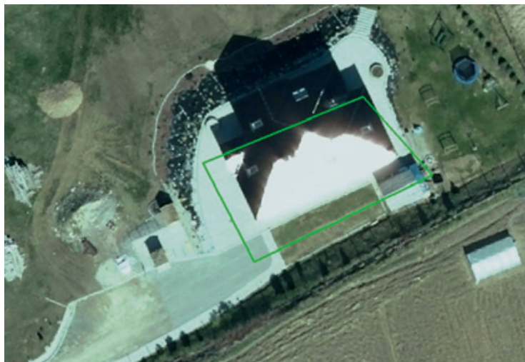
Ryc. 5.26. Błąd radiometrii występujący na cyfrowej ortofotomapie lotniczej
