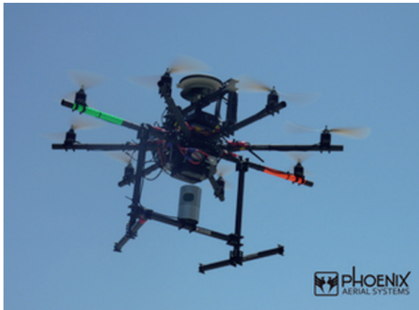
Ryc. 8.1. Drone Phoenix AL-2 ze skanerem Velodyne HDL-32E generujący do 700 000 impulsów na sekundę (źródło: Phoenix Aerial System)
