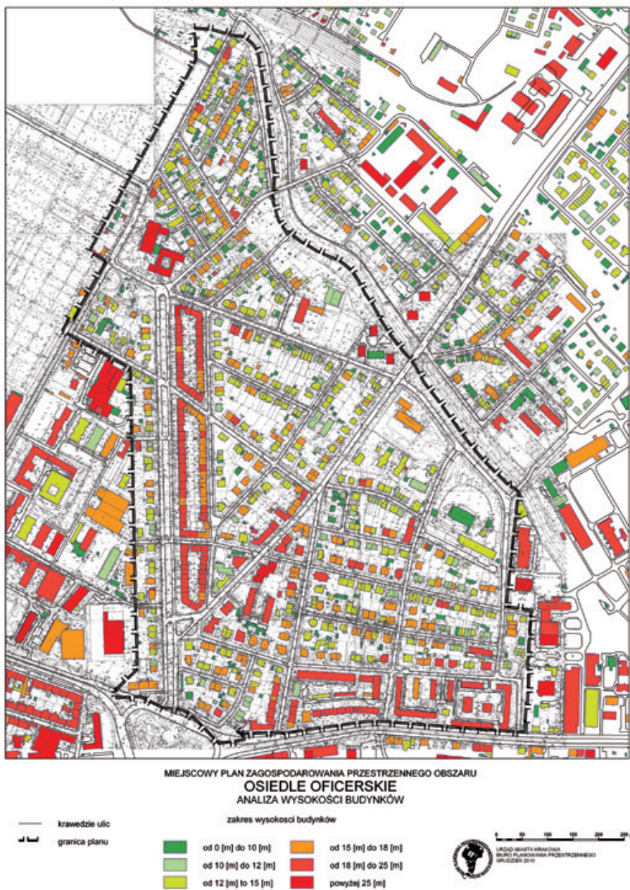
Ryc. 6.39. Mapa będąca efektem zapytania do wektorowej bazy budynków zawierającej atrybuty wysokościowe pozyskane z chmury punktów (oryginał w większej skali; źródło: Biuro Planowania Przestrzennego Urzędu Miasta Krakowa)
