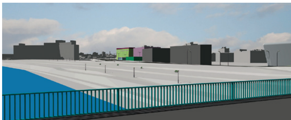
Ryc. 6.42. Wizualizacja planowanej zabudowy z wykorzystaniem wektorowego modelu 3D miasta powstałego na bazie chmury punktów ALS (źródło: Urząd Miasta Krakowa)
