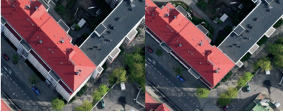
Ryc. 6.64. Budynek z fragmentem fasady na klasycznej ortofotomapie (z lewej) oraz w prawidłowym położeniu ortogonalnym na tzw. prawdziwej ortofotomapie lotniczej (z prawej)
