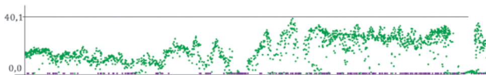
Ryc. 6.49. Profil przez chmurę punktów ALS z wysokościami względnymi (0,0–40,1 m) po normalizacji
