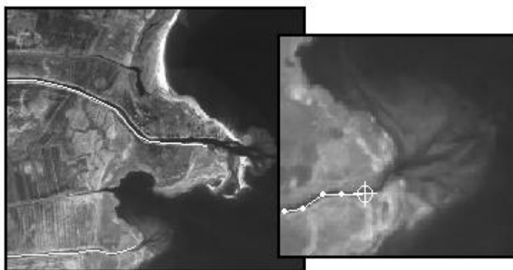
Rys. 3.36 Digitalizacja ekranowa. Za pomocą kursora wprowadza się obiekty warstwy wektorowej punkt po punkcie (wykorzystanie możliwości powiększania obrazu).
