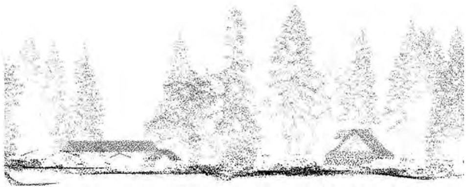
Ryc. 14.5.1.1. Obraz chmury punktów ALS. Profil: szerokość 10 m, gęstość ok. 20 pkt/m 2 (źródło: ProGea Consulting; Zakopane 2007)
