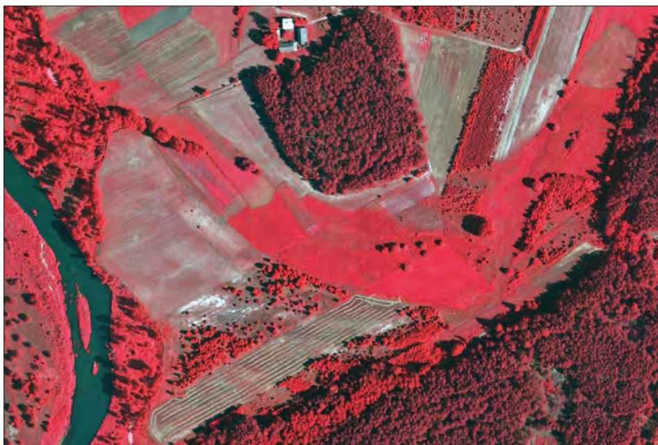
Ryc. 14.2.3. Zdjęcie barwne w podczerwieni, określane również jako zdjęcie spektrostrefowe albo zdjęcie w barwach nierzeczywistych lub fałszywych (źródło: PGL LP)
