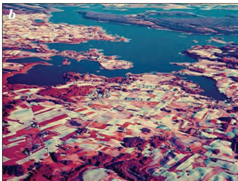
Ryc. 14.1.14. Przykłady zdjęć (a – terenowe, b – lotnicze), wykonanych na barwnym filmie w podczerwieni (Kodak Aerochrom IR 2443).
