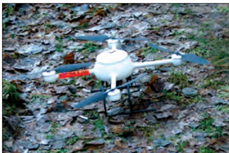
Ryc. 14.8.1.1. Przykłady bezpilotowych śmigłowców mających na celu wykonywanie zdjęć podczas zautomatyzowanych i zdalnie sterowanych lotów: a – model MD4-200 firmy Microdornes GmbH, b – model MS EAGLE, zaadaptowany przez Politechnikę Gdańską i firmę Microsystem
