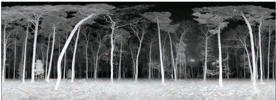
Ryc. 14.5.2.5. Obraz planarny (2D) chmury punktów TLS (360°). Drzewostan So-Db w Puszczy Niepołomickiej (skaner TLS FARO LS 880, stanowisko centralne S_1, pow. badawcza TR1), (źródło: P. Wężyk)
