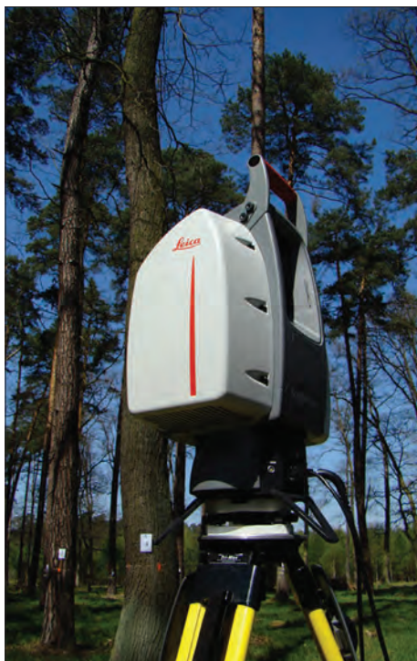
Ryc. 14.5.2.11. Skanery TLS na poligonie badawczym w Puszczy Niepołomickiej i w Tatrach. U góry od lewej: FARO Photon 80, Topcon GLS-1000; u dołu od lewej: Leica ScanStation2 oraz Riegl LPM-321 (źródło: P. Wężyk)
